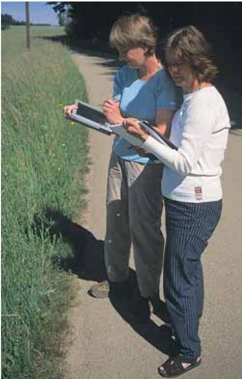
Strukturen und Nutzungen werden im Gelände mit Hilfe von mobilen Feldrechnern in einem Geographischen Informationssystem (GIS) erfasst.
