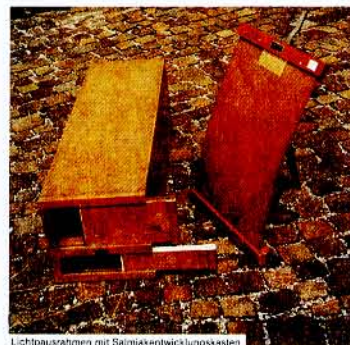
Lichtpaletten mit Salmiakentwicklungsplatten
